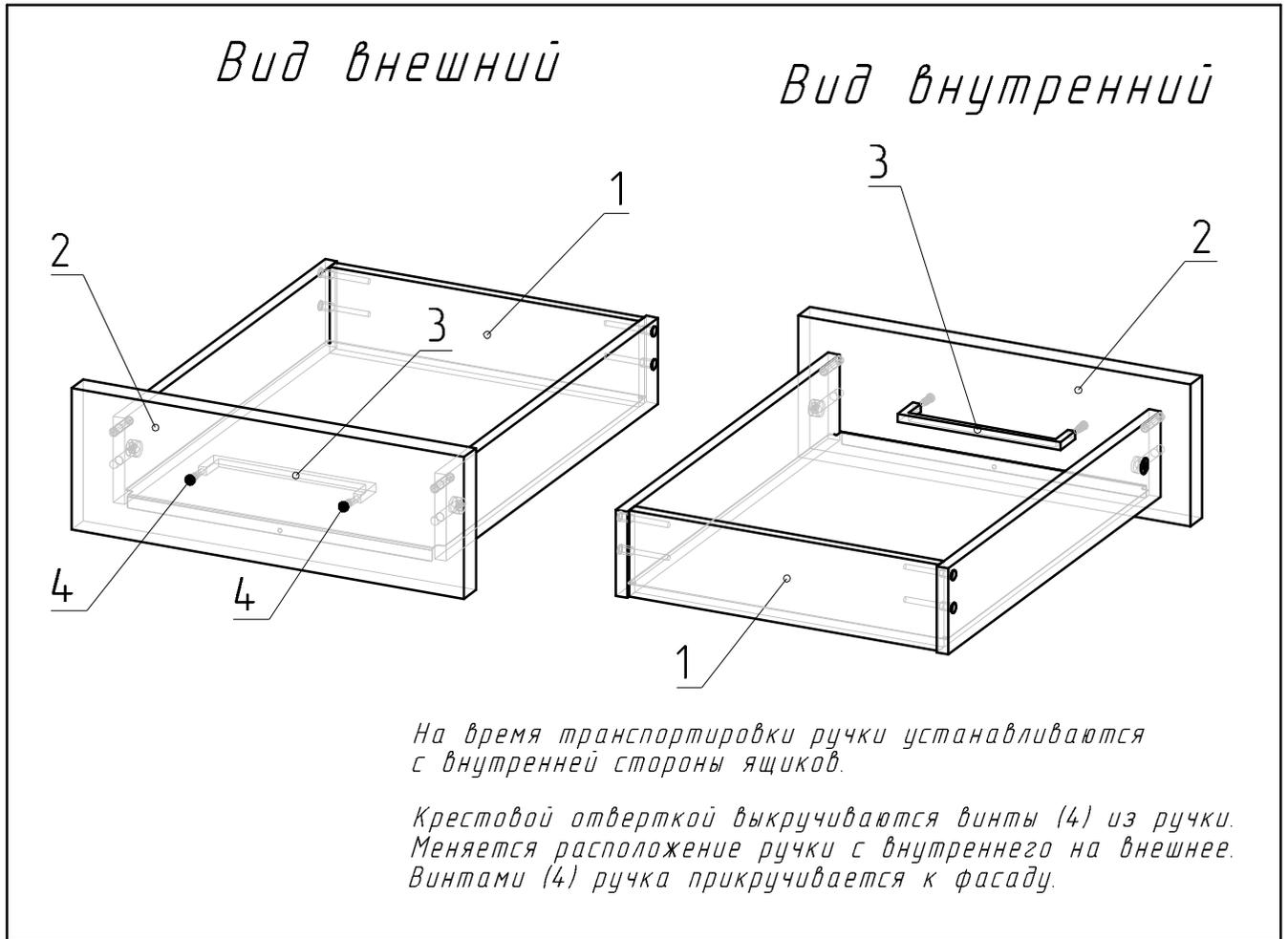
На время транспортировки ручки устанавливаются с внутренней стороны ящиков.
